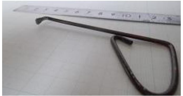
図 2 1 ベアリングを引き出すための特殊工具を作る
