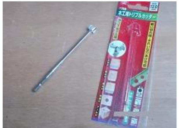
図46のドリル歯でも、掘った穴の内壁との摩擦による減速があり、一回3mmくらい掘ったら一度歯を上にあげて回転数を回復させます。それを繰り返して24mmの厚さを貫通する穴をあけます。
